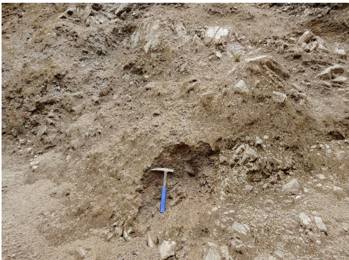
Fotografía 2. Depósito coluvio deluvial conformado por bloques, gravas, arenas, limos y un ligero contenido de arcillas.
