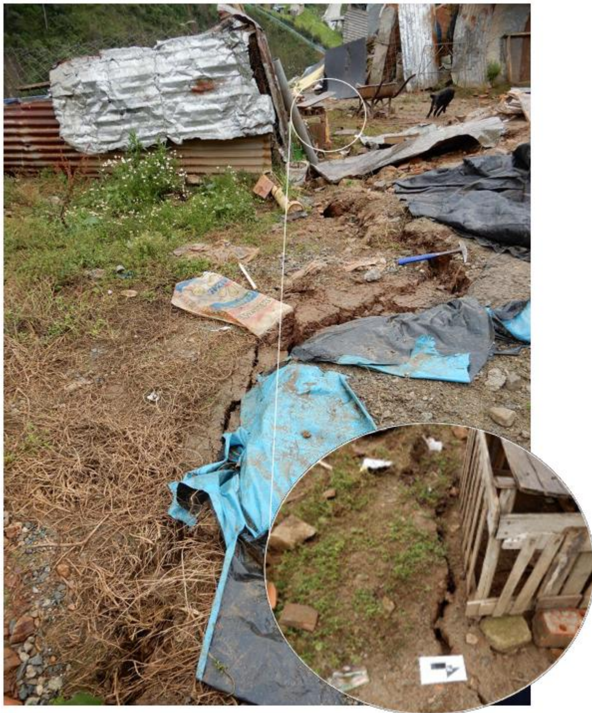
Figura 12. Grieta de tracción que reflejan un desplazamiento del terreno de hasta 15 cm de abertura situada en la parte superior de la zona de arranque del derrumbe, lo que, evidencia una zona potencialmente disponible a desplazarse ladera abajo.
