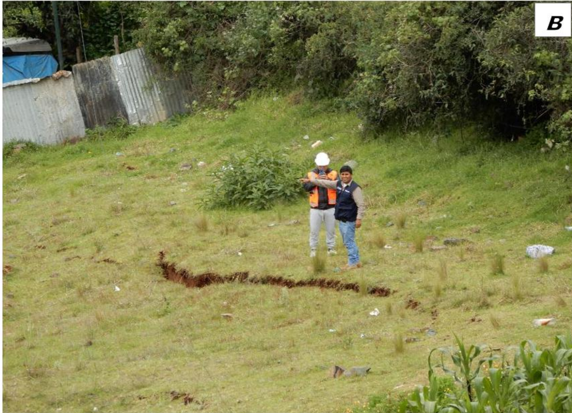
Figura 10. Grietas que evidencian el desplazamiento del terreno localizados en el flanco superior derecho del derrumbe.
